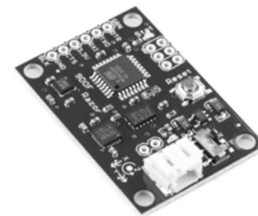
Rys. 1. Inercyjny układ pomiarowy Razor-IMU-9DOF[2]
